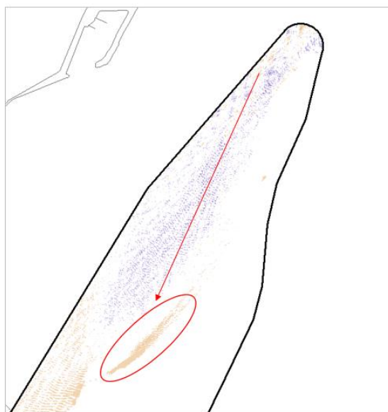
Figuur 5-14: Erosie op de noordflank van de noordelijke zandtong van de plaatrandstortzone van de Rug van Baarland. Sedimentatie komt voor ten zuiden, op de lijzijde, van de ondiepe zone aanwezig op de noordelijke zandtong.
