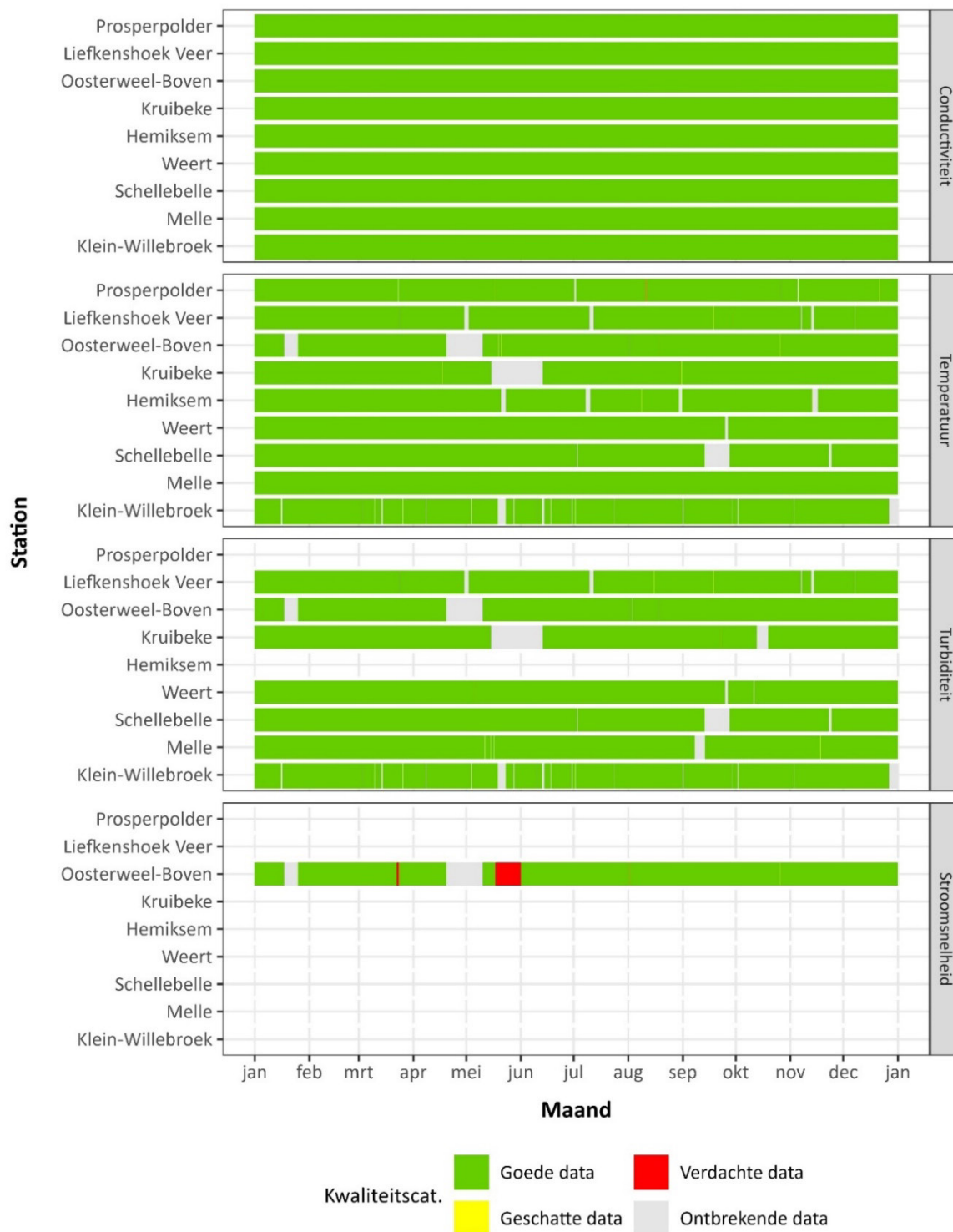
Figuur 31 – Overzicht van de datakwaliteit per parameter en per station voor de continue metingen fysische parameters (meetfrequentie 5 min) voor 2023. Voor Prosperpolder en Hemiksem is de frequentie van conductiviteit en temperatuur lager (10 min).
