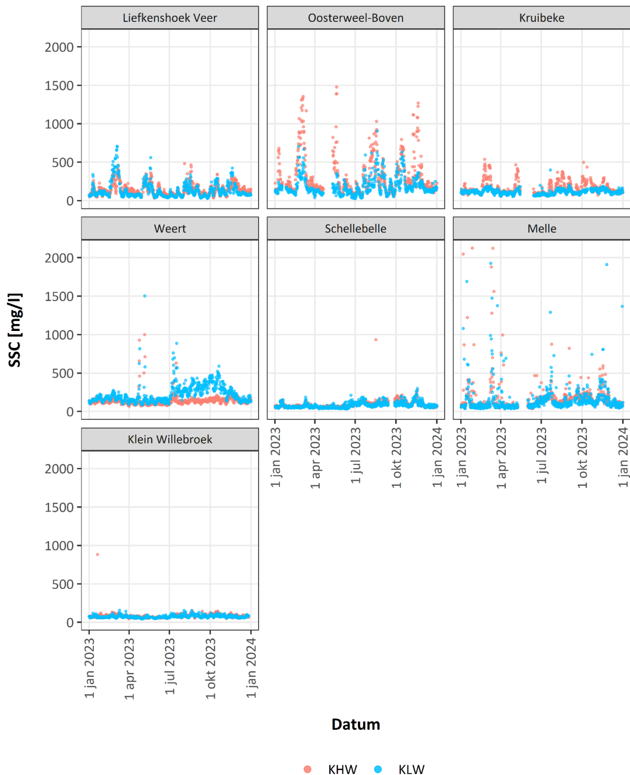
Figuur 53 – SSC (maxima) verloop in 2023 tijdens eb/vloed voor de verschillende meetstations.
