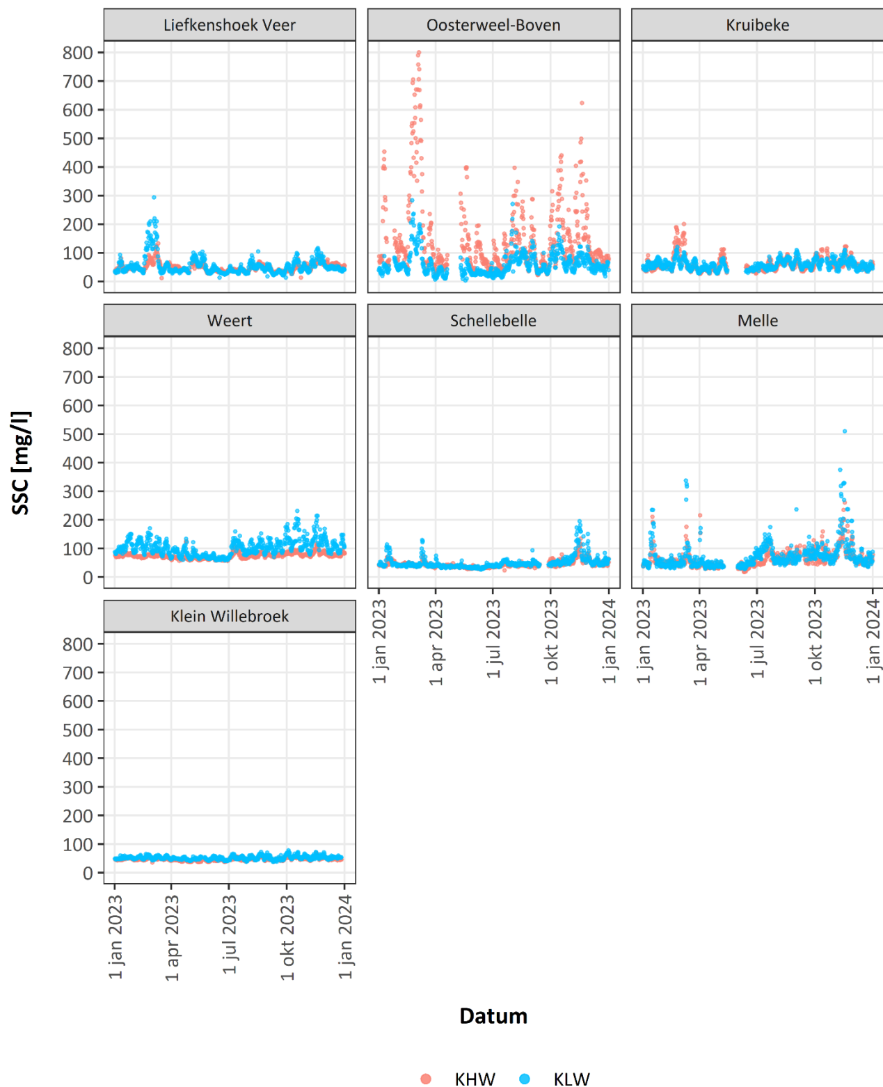
Figuur 51 – SSC (minima) verloop in 2023 tijdens KHW en KLW voor de verschillende meetstations.
